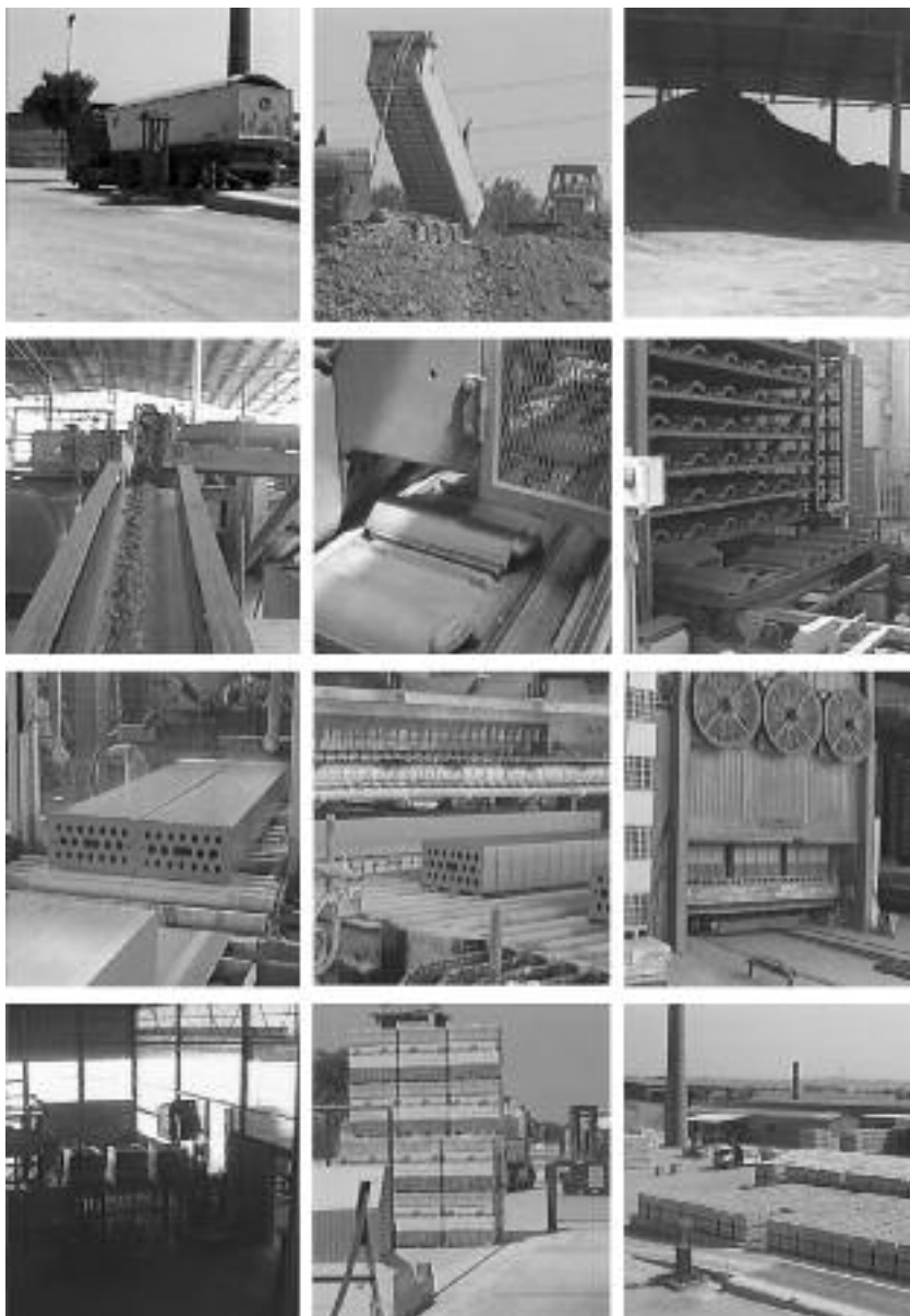
Fig. 7 - Ricostruzione fotografica delle fasi di produzione delle tegole e dei forati dall'arrivo delle materie prime allo stoccaggio dei prodotti finiti nel piazzale della ciminiera.
